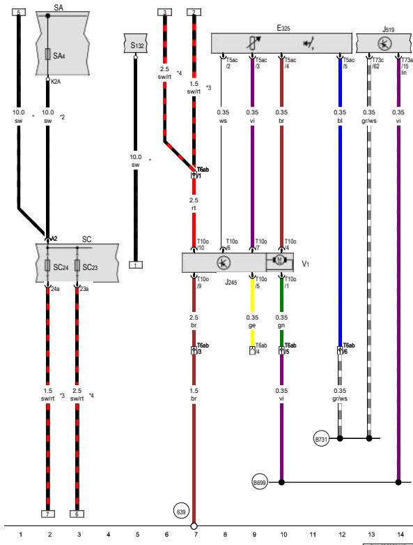
**滑动天窗按钮, 滑动天窗控制单元, 车载电网控制单元, 保险丝架 C, 滑动天窗电机**
